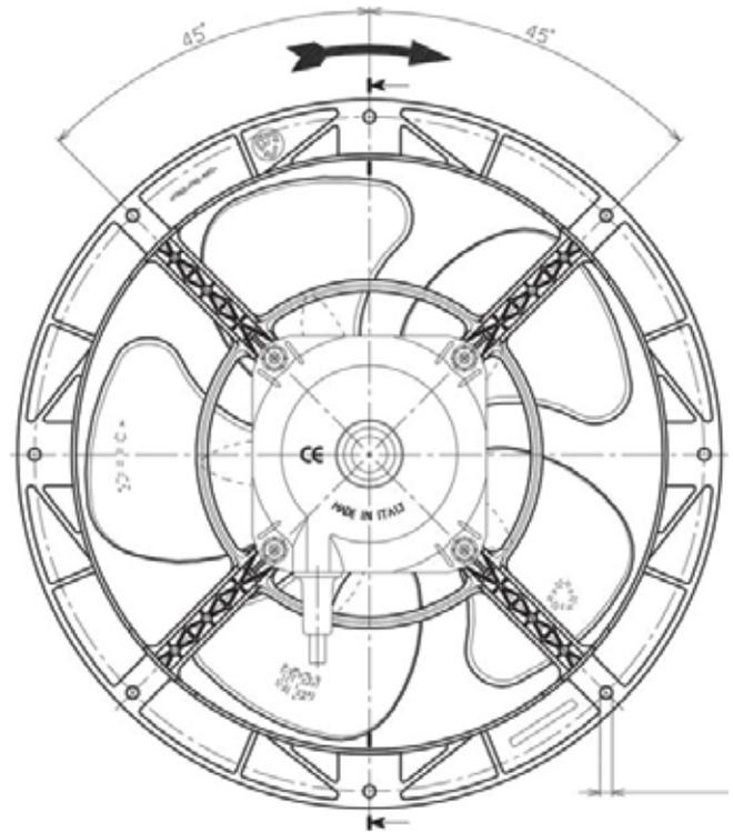
Umluftventilatoren mit angegossenem Luftführungsring aus Nylon 6/6, glasfaserverstärkt, selbstverlöschend, 3-adriges Anschlusskabel.
