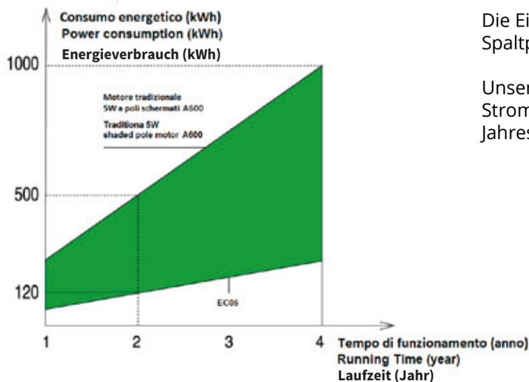
Die Eingangsleistung eines herkömmlichen Spaltpolmotors (GT 5) liegt bei 29 Watt.
